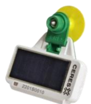
牛の耳に取り付けるGPSタグ
